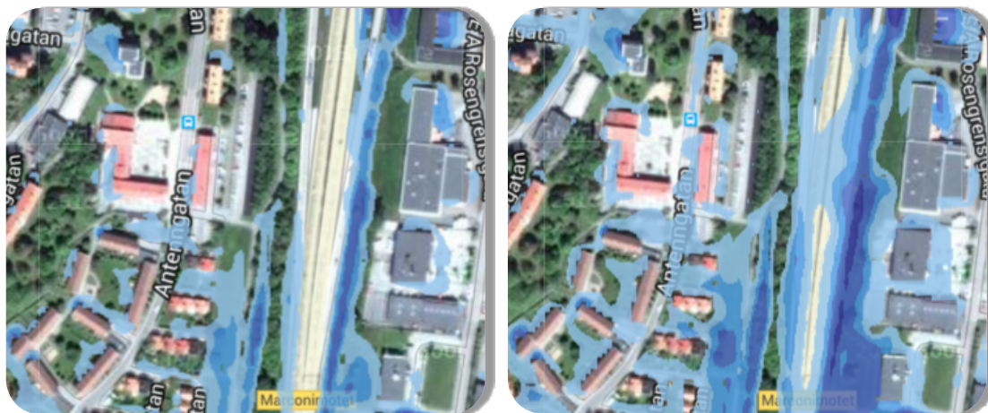
Figur 5: Resultat av skyfallsmodellering. 100 års regn till vänster, 500 års regn till höger
